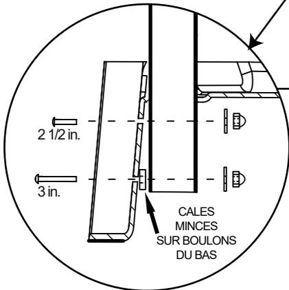
2) Assemblez les deux poteaux du bas. Utilisez une règle pour identifier les bons boulons; deux boulons de 2 1/2" et deux de 3". Complétez l'assemblage en suivant les indications de la vignette poteaux du bas. Ne serrez pas tout de suite.
