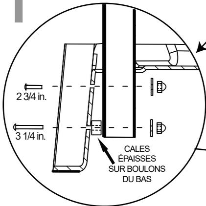
1) Débutez l'assemblage par les 2 poteaux du haut. Utilisez une règle pour identifier les bons boulons; deux boulons de 2 3/4" et deux de 3 1/4". Utilisez les cales les plus épaisse, les écrous et les rondelles plates. Assemblez comme le montre la vignette de gauche intitulé poteaux du haut. Ne pas serrer tout de suite.
