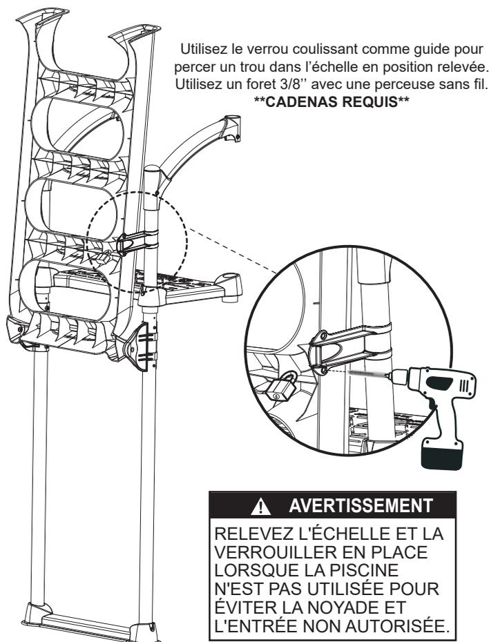
Utilisez le verrou coulissant comme guide pour percer un trou dans l'échelle en position relevée. Utilisez un foret 3/8" avec une perceuse sans fil.
